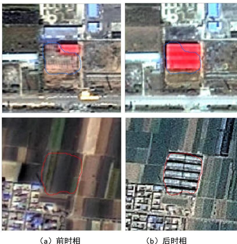
图5 新增建（构）筑物自动提取结果
